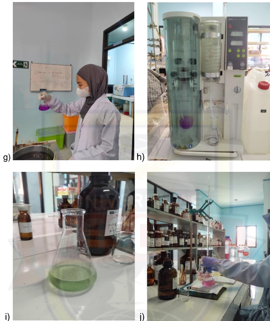
Gambar 15. Uji analisis kadar protein (a) penimbangan sampel; (b) penimbangan ;(c) penambahan asam sulfat; (d) pemanasan diruang asam; (e) penambahan aquades; (f) penambahan NaOH; (g); (h) destilasi; (i) penambahan indicator; (j) titrasi HCl 0,2 N.
