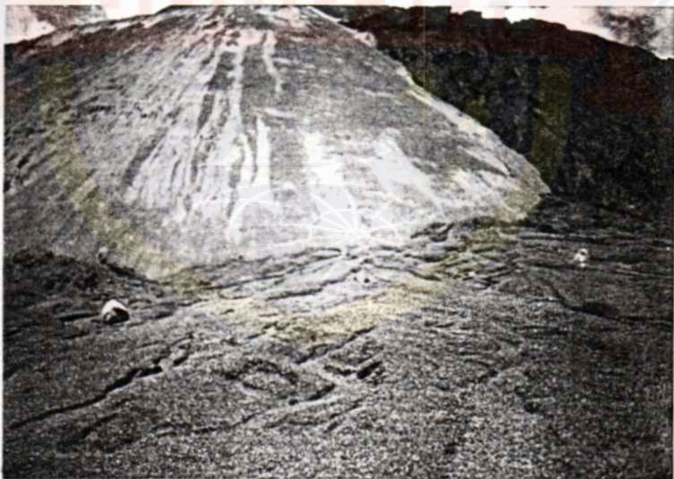
Tahap VI : Penampungan agregat halus ( abu batu ) pada areal pe - nampungan , selanjutnya abu batu siap digunakan .
