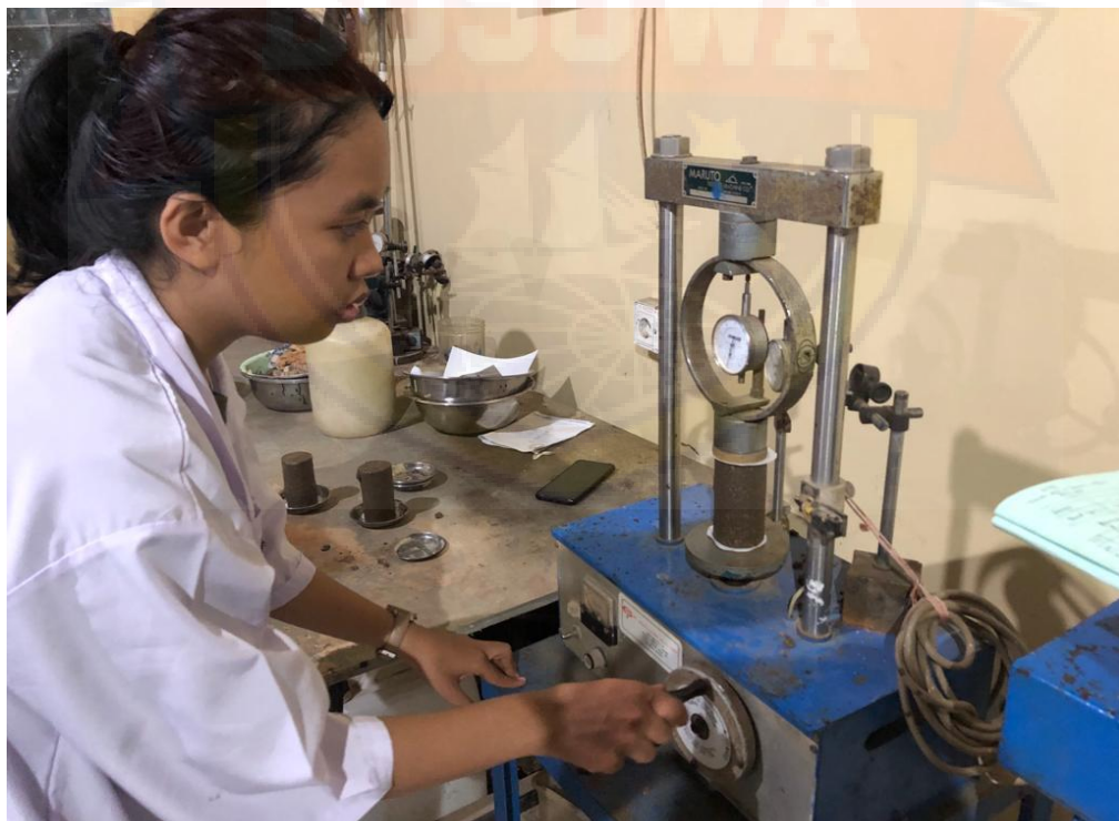
PENGUJIAN KUAT TEKAN
