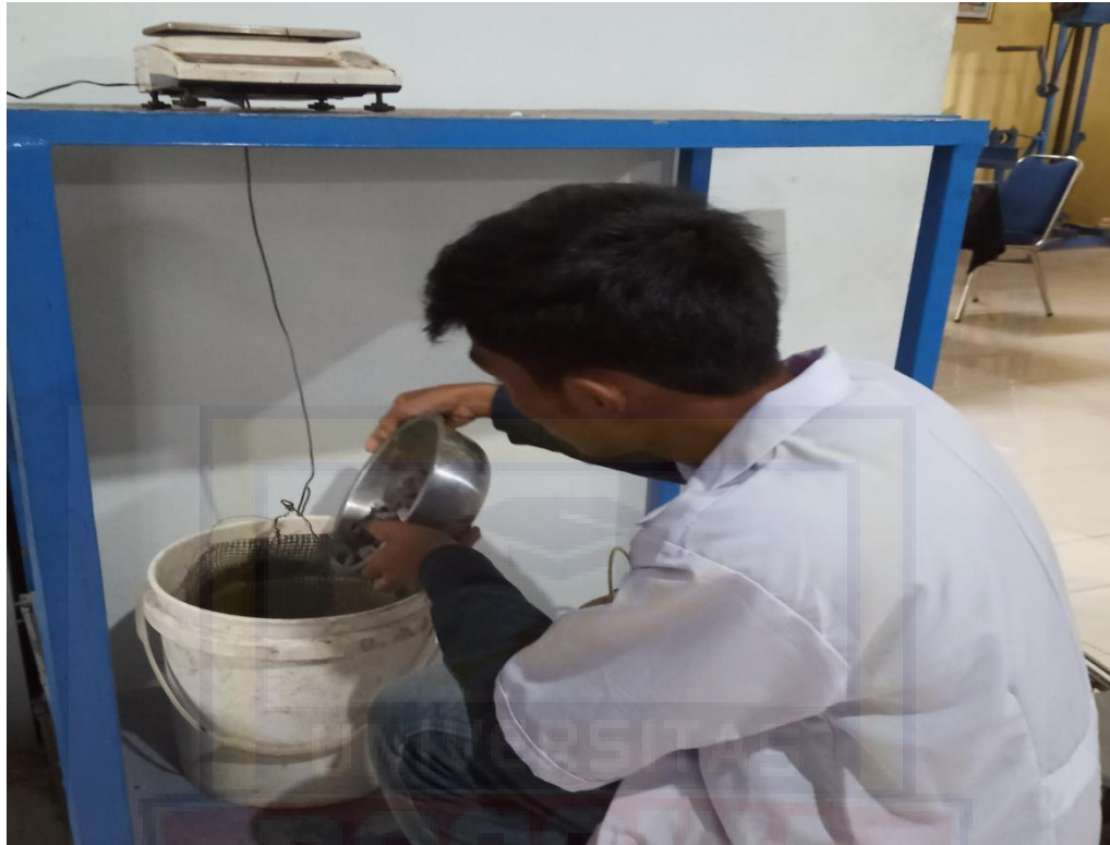
Pengujian Berat Jenis Agregat Kasar
