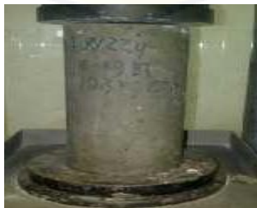
Gambar 3.1 Kuat tekan benda uji silinder
