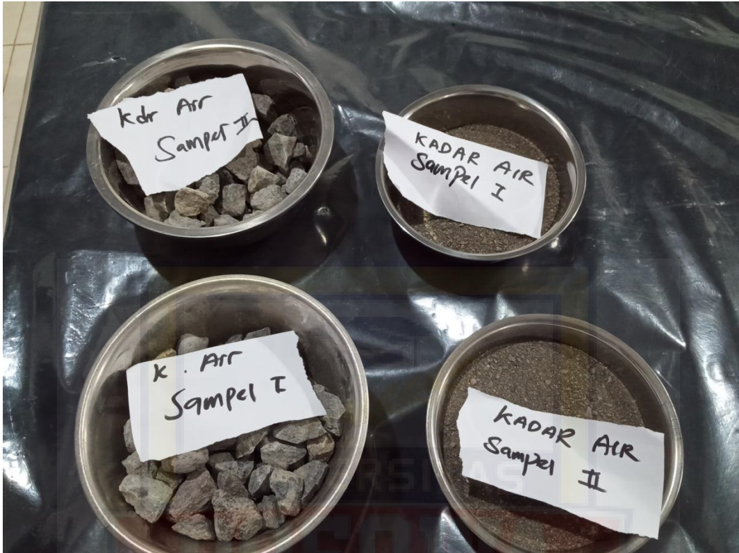
Pengujian kadar air Agregat Kasar Dan Halus
