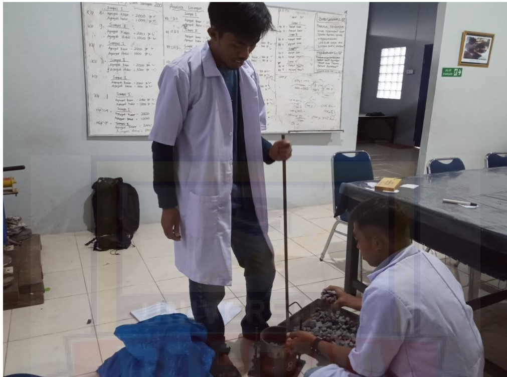
Pengujian berat isi agregat kasar
