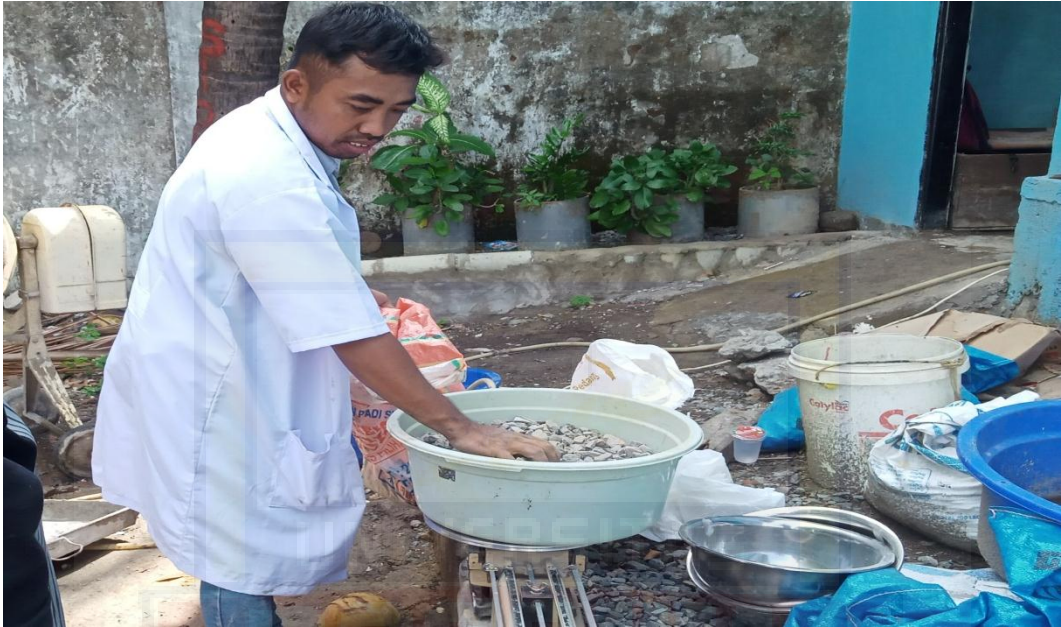
Penimbangan Agregat Untuk Pencampuran Beton Variasi
