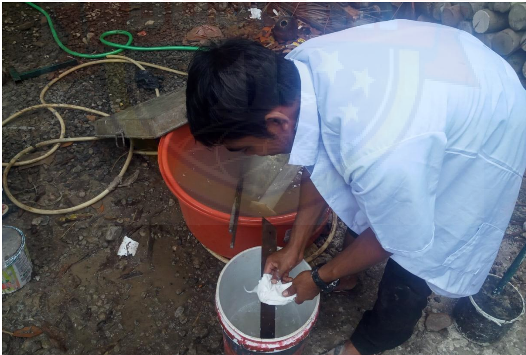
Pencampuran Lem putih PVAc ke dalam Air
