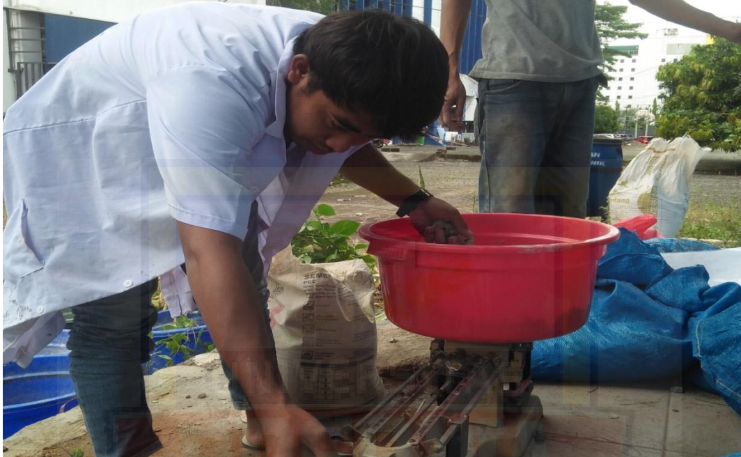
Penimbangan Agregat untuk pencampuran Beton Normal
