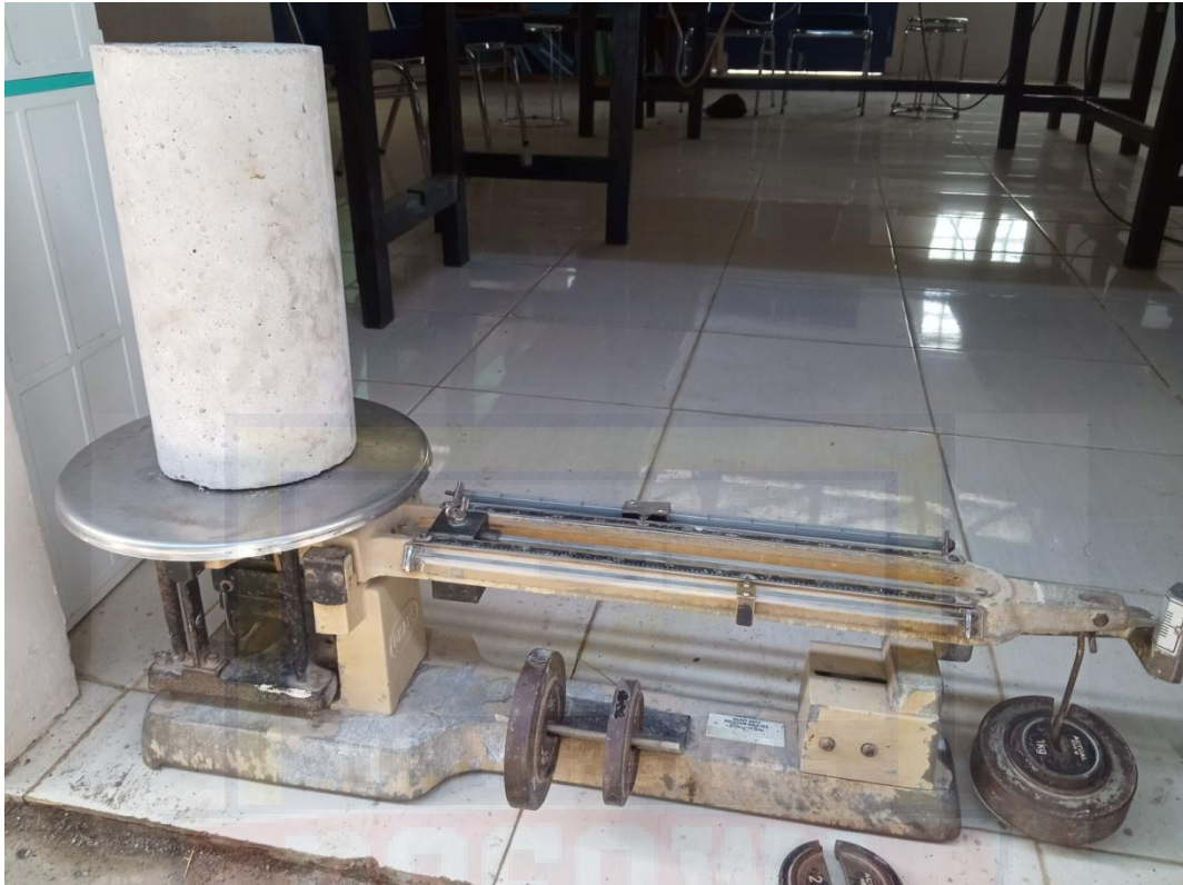
Penimbangan Benda Uji sebelum pengepungan
