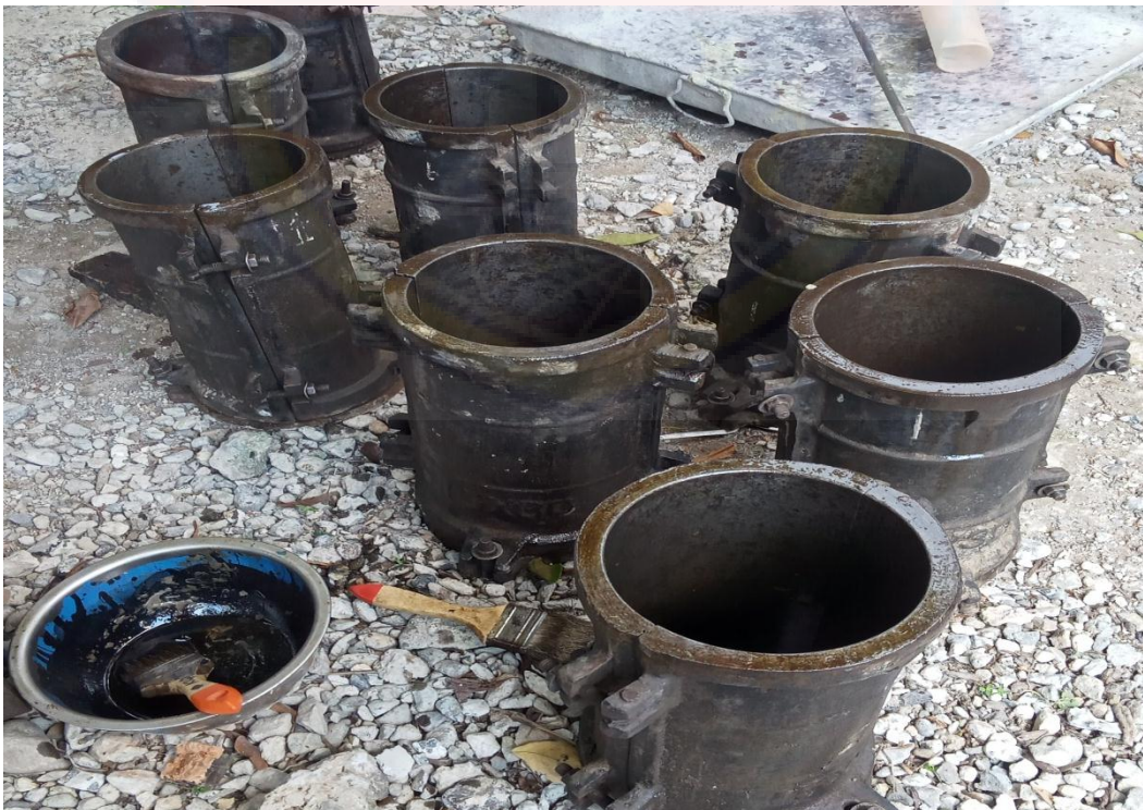
Mempersiapkan Silinder Diameter 15 cm, Tinggi 30 cm
