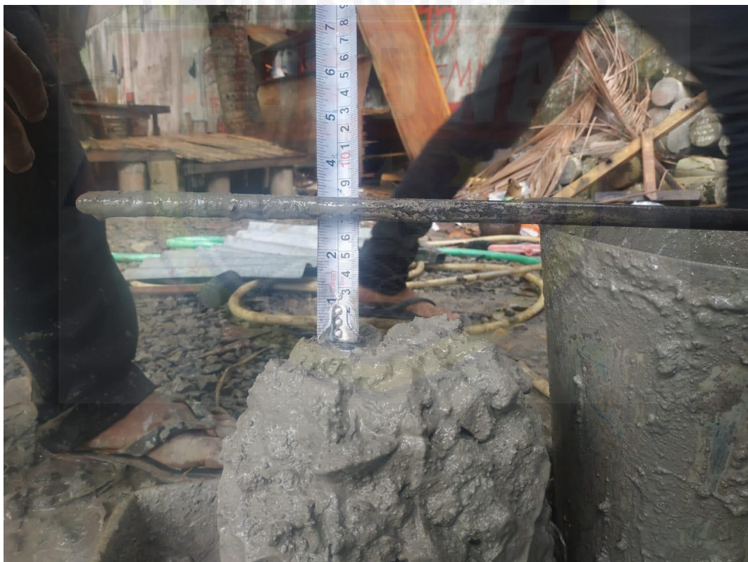
Pengambilan Nilai Slump test Beton Variasi
