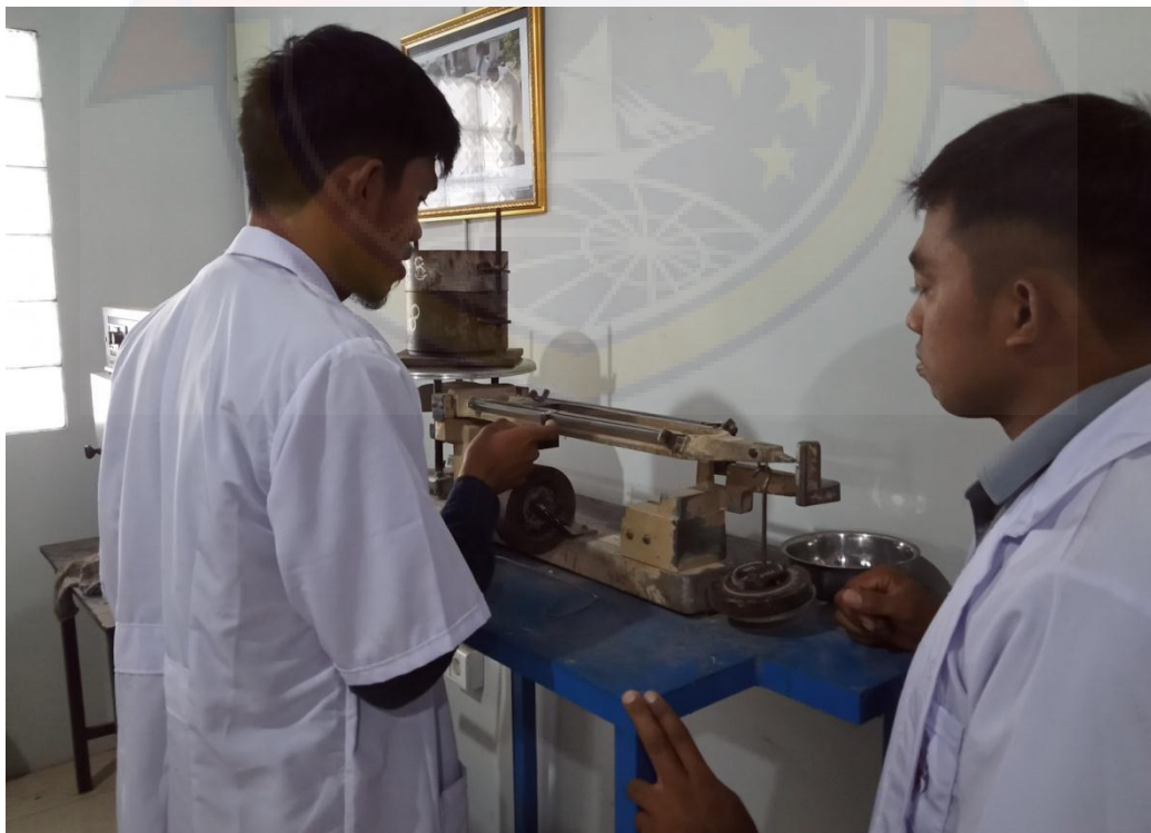
Pengujian berat isi agregat Halus
