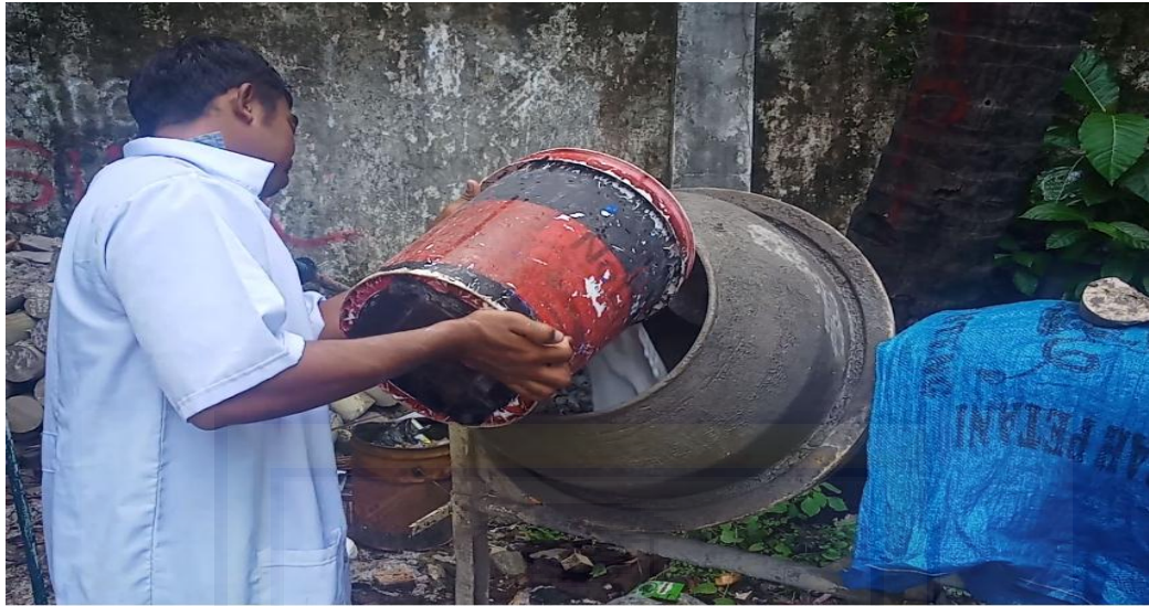
Memasukan Campuran Lem Putih PVAc ke Mesin Pengaduk
