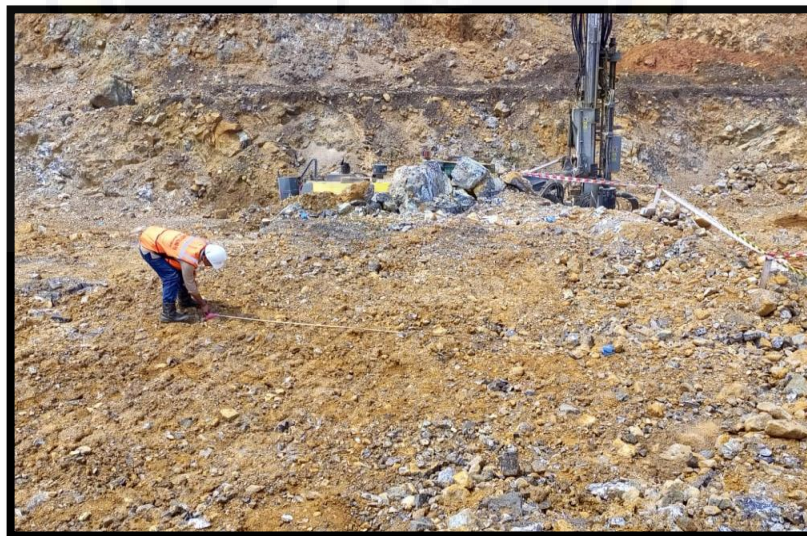
Gambar 2. Pengukuran Spacing dilapangan menggunakan alat ukur meter
