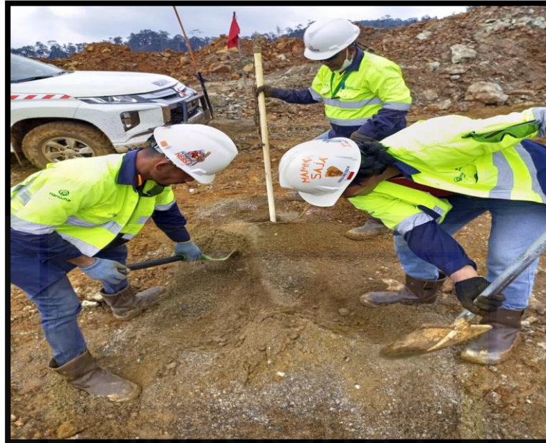
Gambar 3. Pengukuran Stemming dilapangan menggunakan alat ukur.
