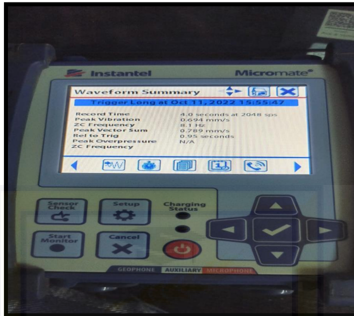
Gambar 9. Hasil pengukuran Ground Vibration tanggal 13 oct 2022
