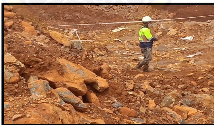
Gambar 4. 11 Proses Kegiatan Perangkaian peledakan Sumber : (PT.Vale Indonesia Tbk)
