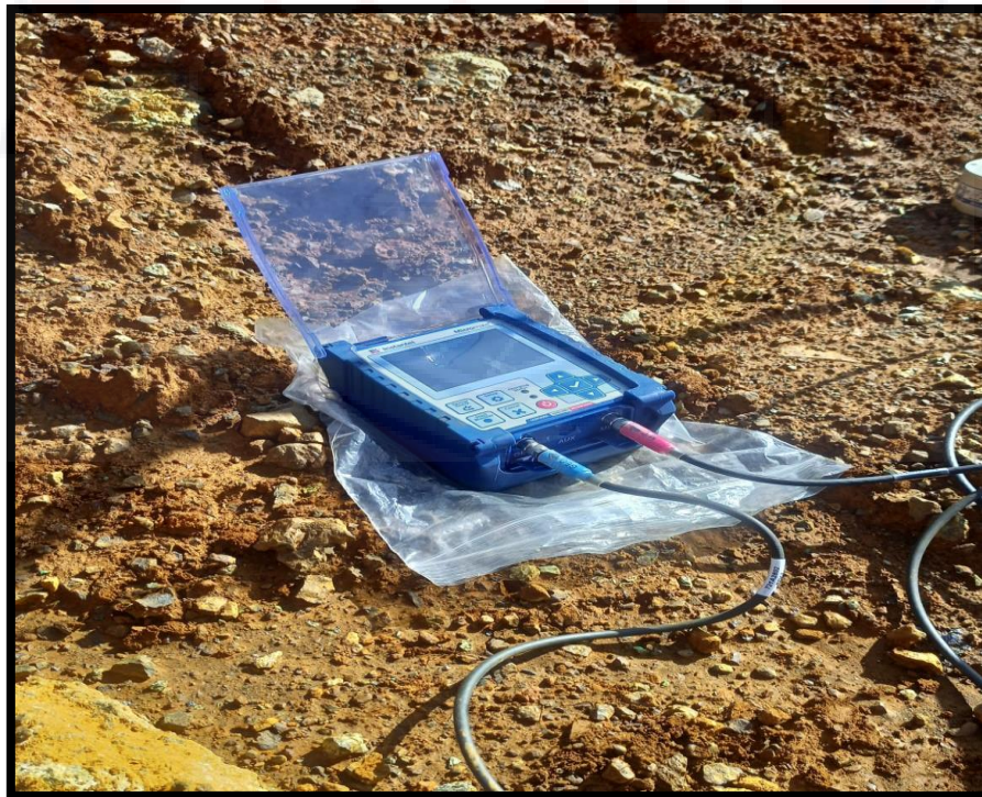
Gambar 4. Pengukuran Getaran dilapangan menggunakan InstanTel Micromate
