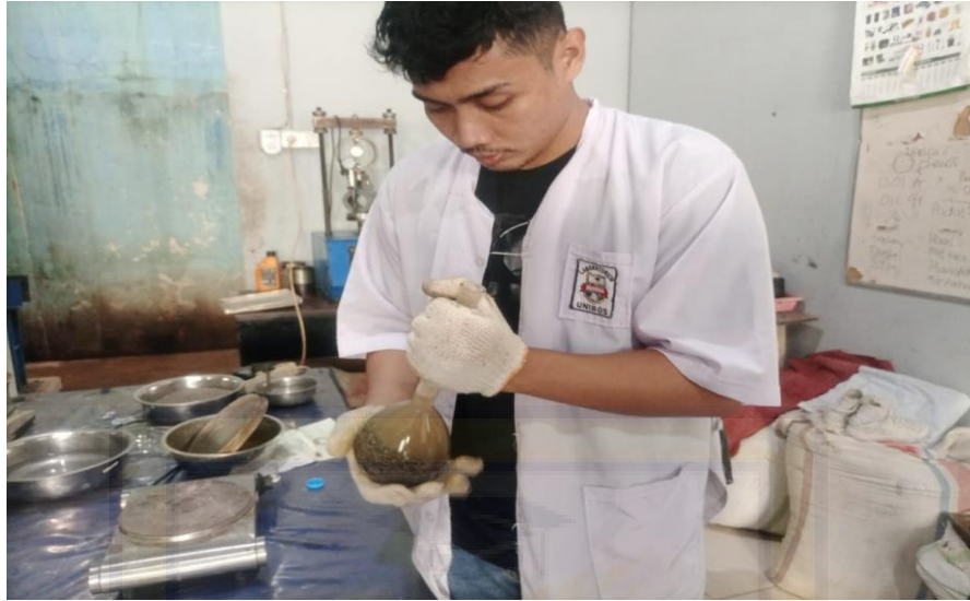
Gambar 5. Pengujian Berat Jenis Agregat Halus
