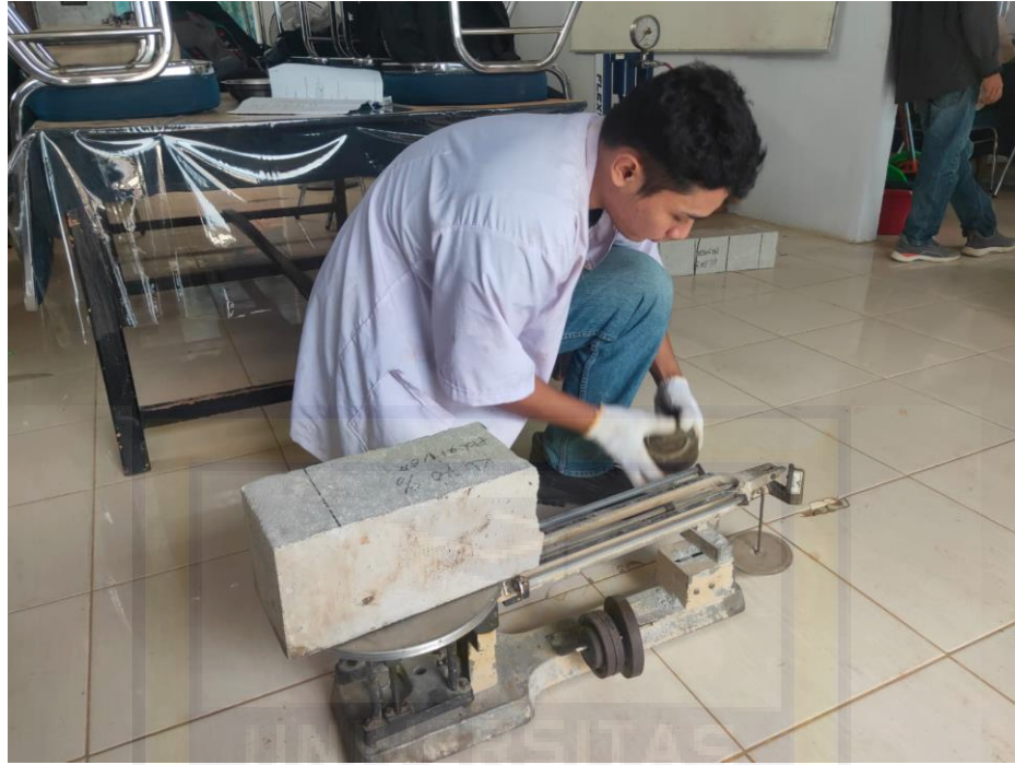
Gambar 21. Proses Penimbangan beton Kuat Lentur
