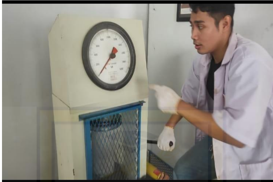
Gambar 17. Proses pengujian kuat beton
