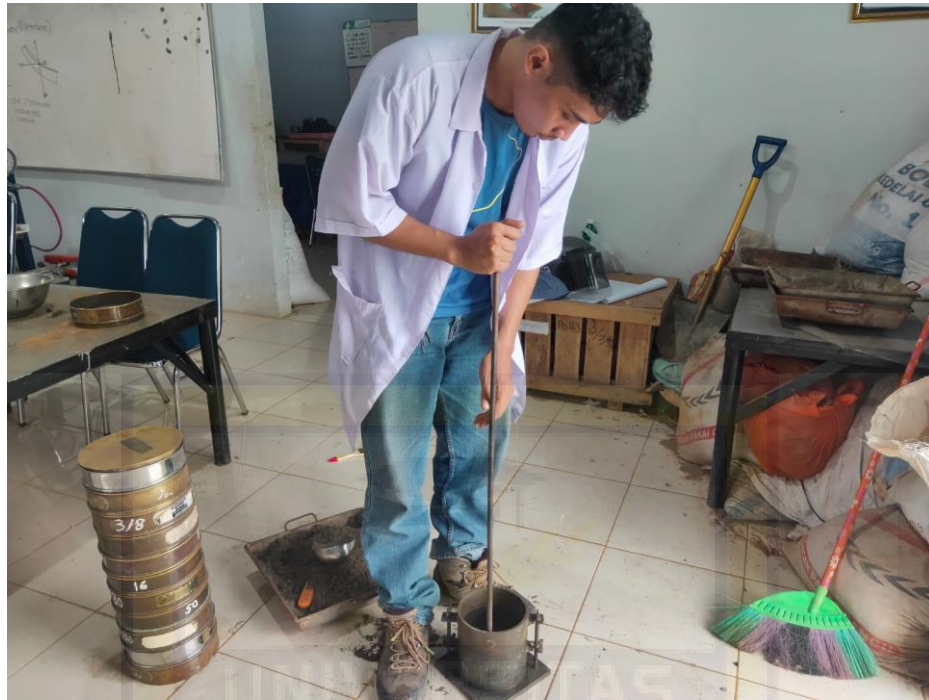
Gambar 11. Proses Untuk Pengujian Berat Isi
