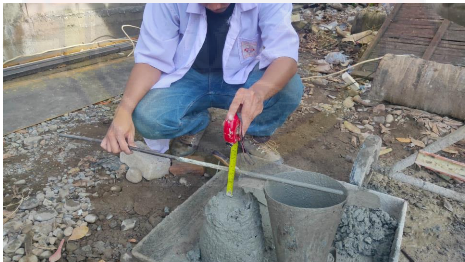
Gambar 14. Proses Pengukuran Tinggi Slump
