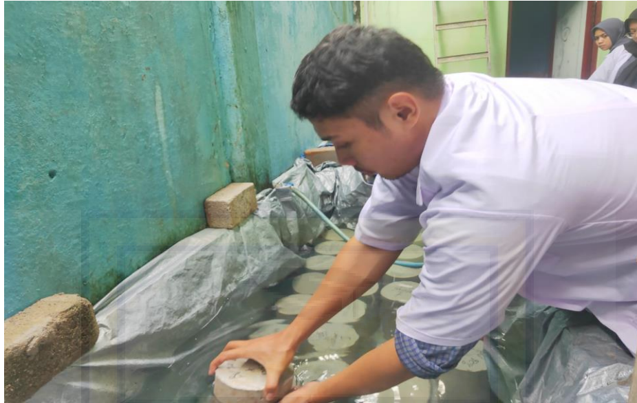
Gambar 15. Proses prendaman Beton selama 28 hari
