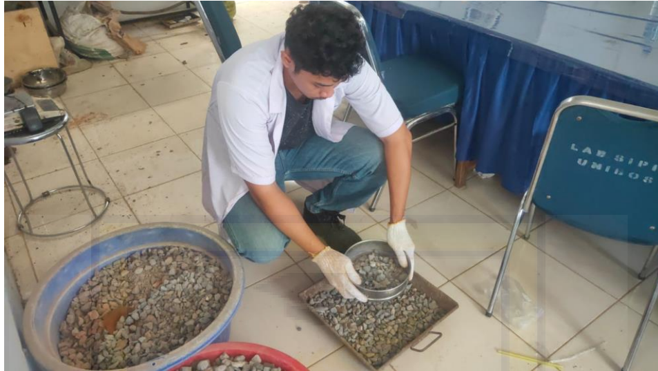
Gambar 3. Proses Penyaringan Agregat Kasar Menggunakan Saringan \frac{3}{4}
