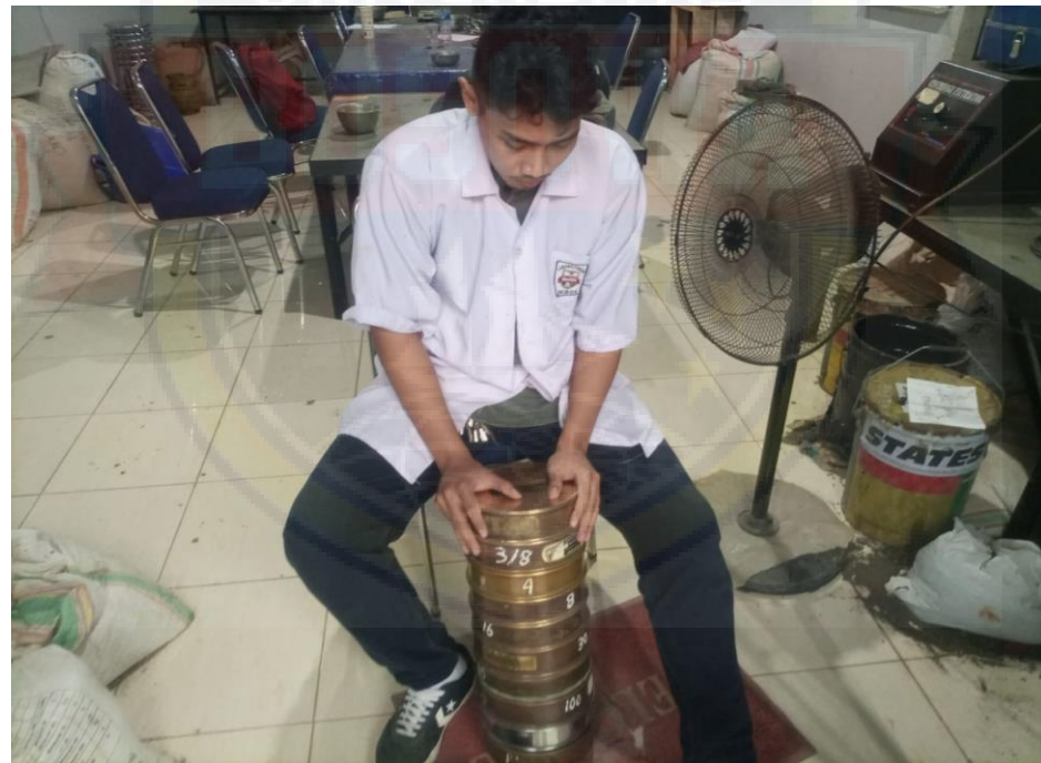
Gambar 8. Pengujian Analisa Saringan
