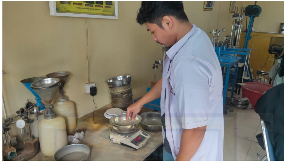
Gambar 7. Penimbangan Agregat Kasar Untuk Pengujian Kadar Air
