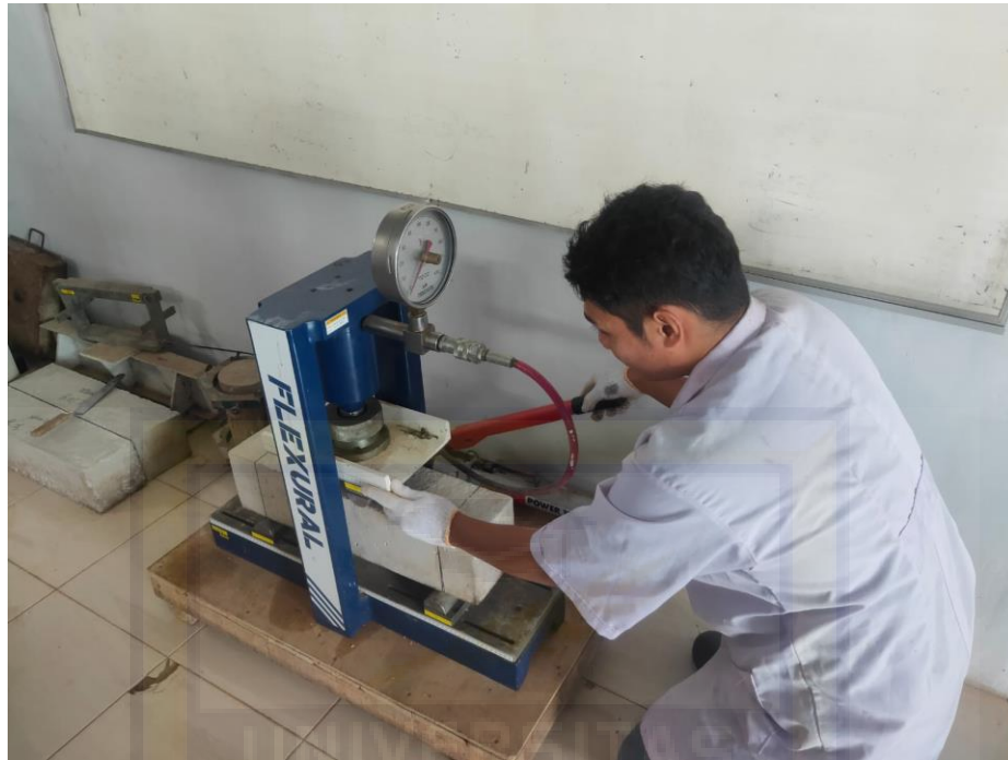
Gambar 19. Proses pengujian kuat lentur beton
