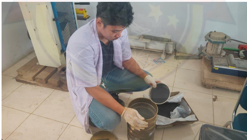
Gambar 12. Proses Penyaringan Pasir Besi Menggunakan Satu Set Saringan.
