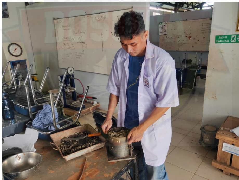
Gambar 10. Proses Pengisian Agregat Kedalam Mold Untuk Pengujian Berat Isi
