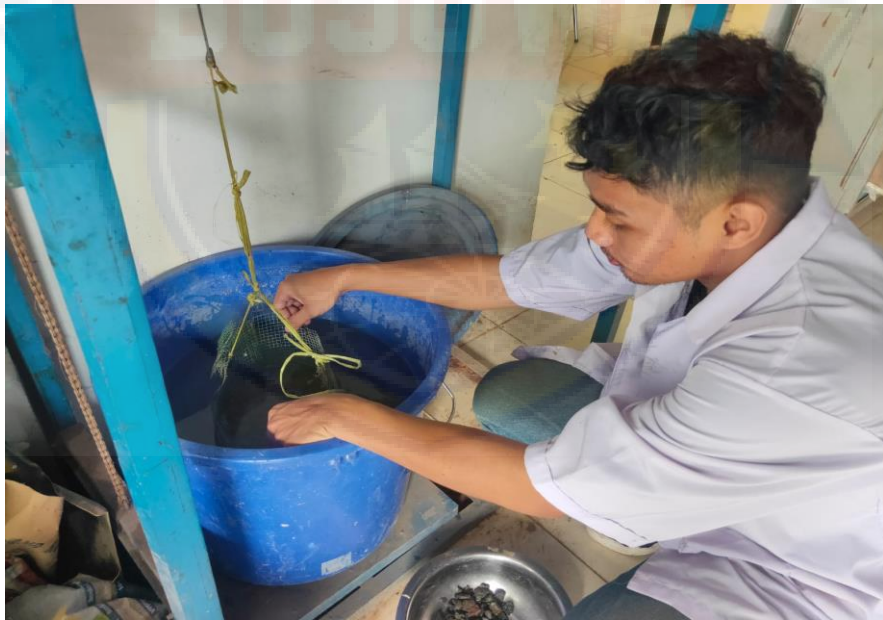
Gambar 6. Pengujian Berat Jenis Agregat kasar
