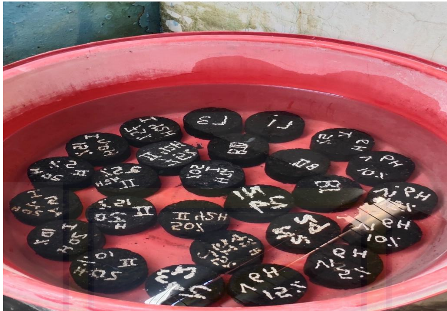
Melakukan perendaman sampel selama 24 jam
