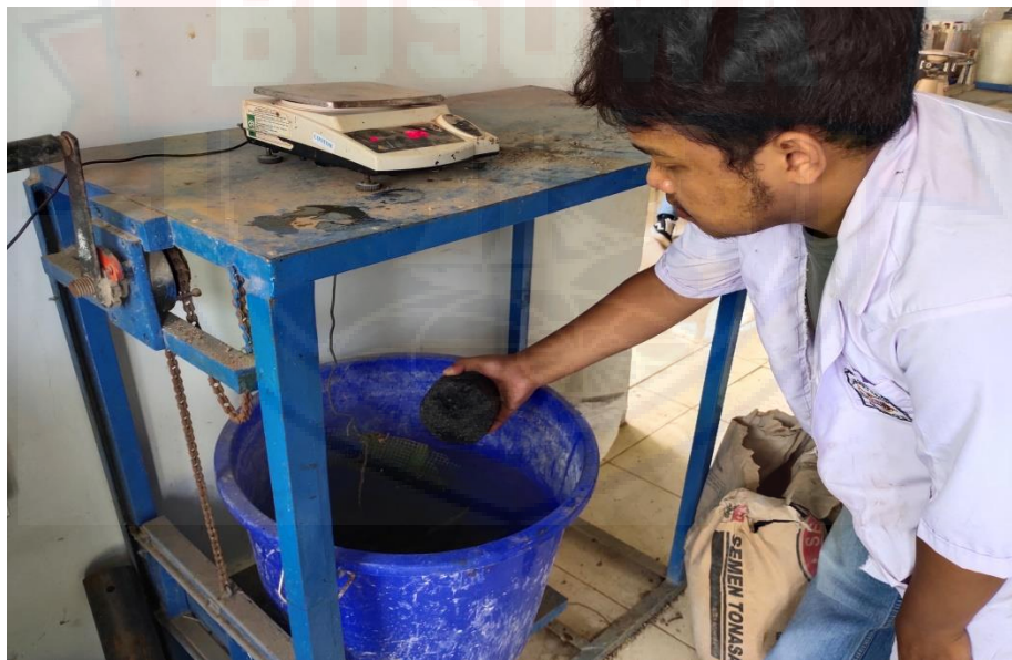
Menimbang sampel dalam air pada kondisi kering – permukaan jenuh
