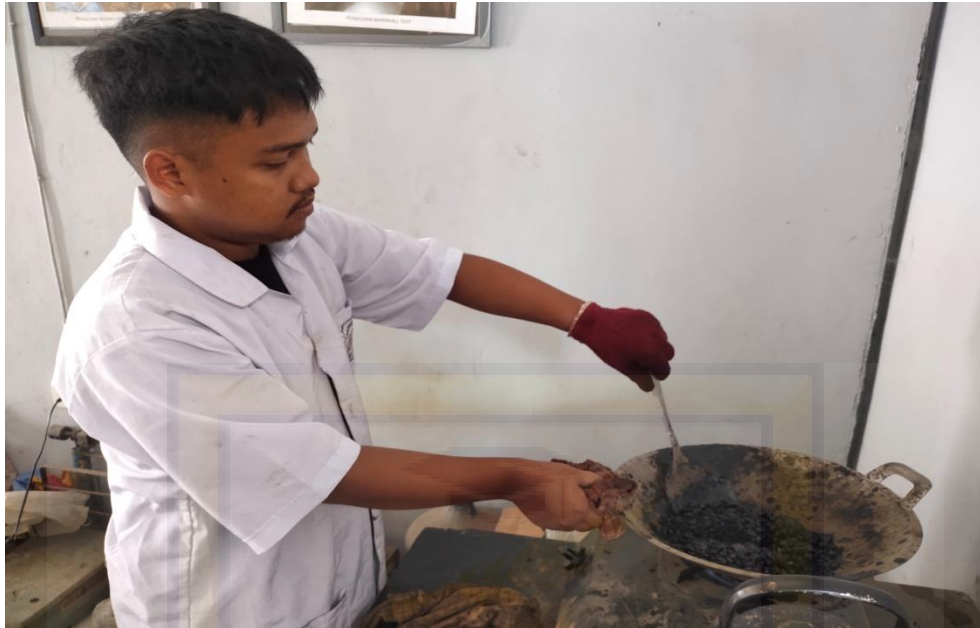
Memanaskan campuran agregat yang sudah tercampur aspal
