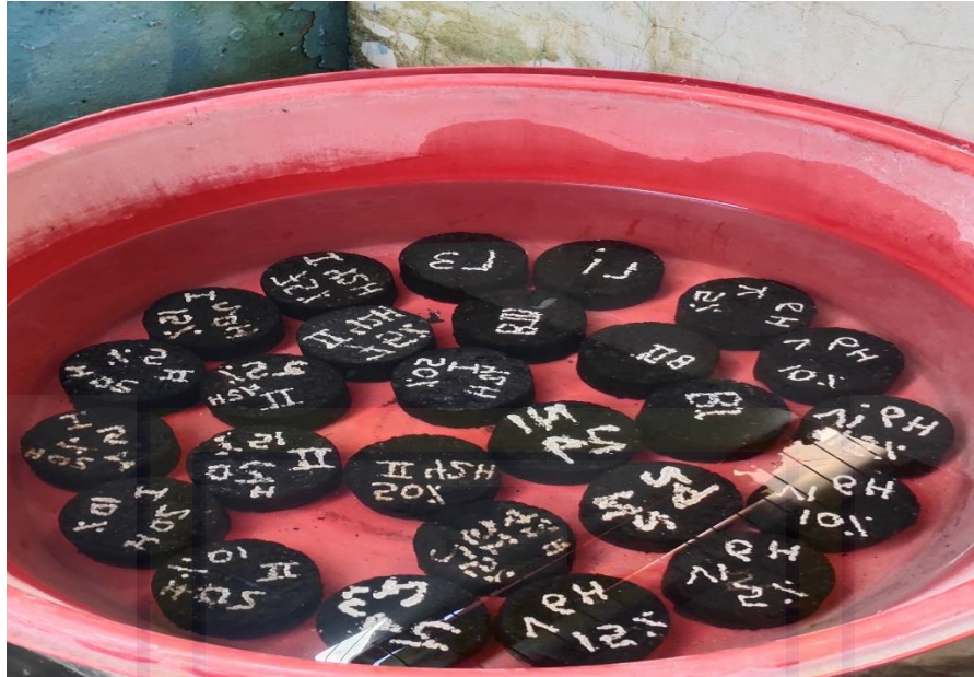
Melakukan perendaman sampel selama 24 jam
