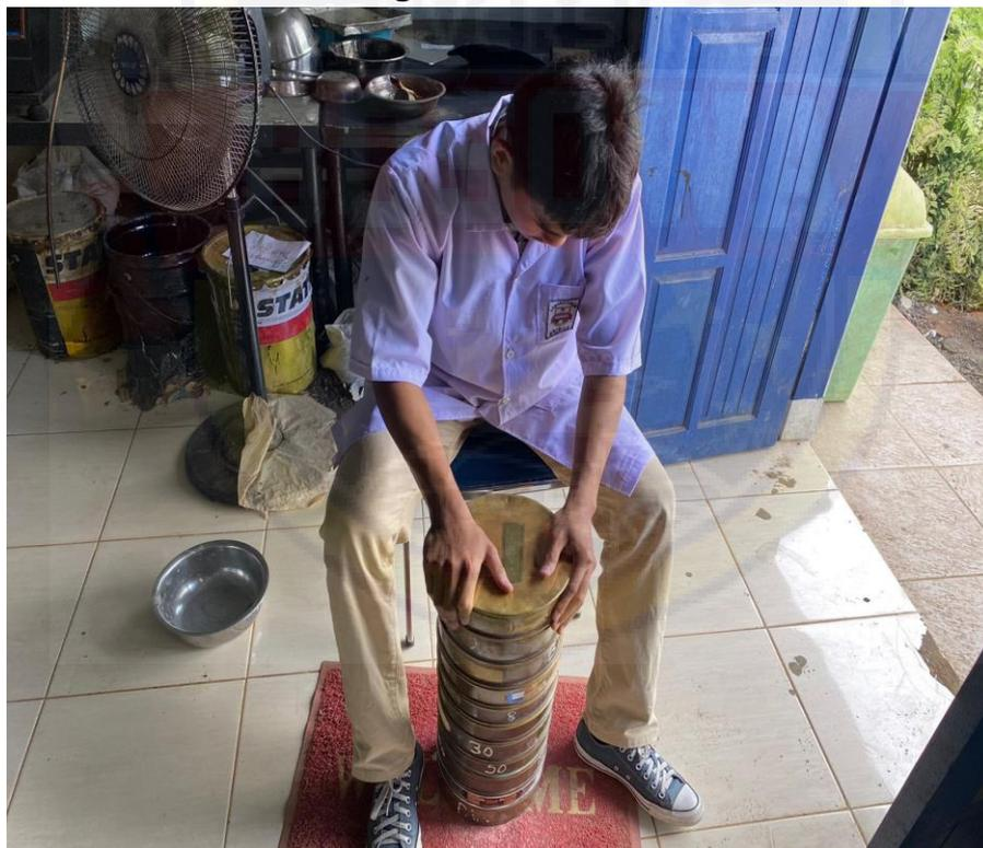
**Proses Analisa Saringan Material Pembuatan Sampel**
