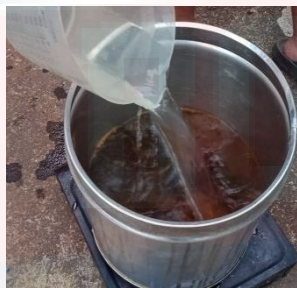
Memasukkan methanol dan KOH Pada suhu 60°C
