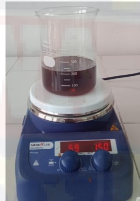
Pemanasan untuk menguapkan sisa air
