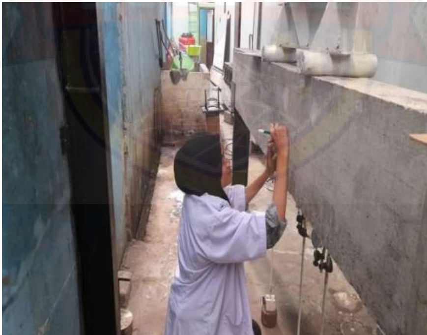
Gambar 6 Proses pengujian balok beton
