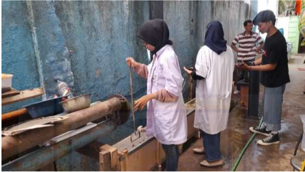
Gambar 3 Proses pembuatan balok beton
