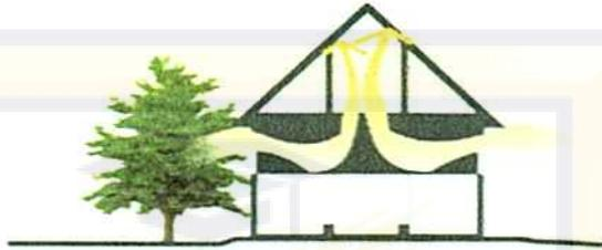
Gambar 5. 16 sistem penghawaan alami
