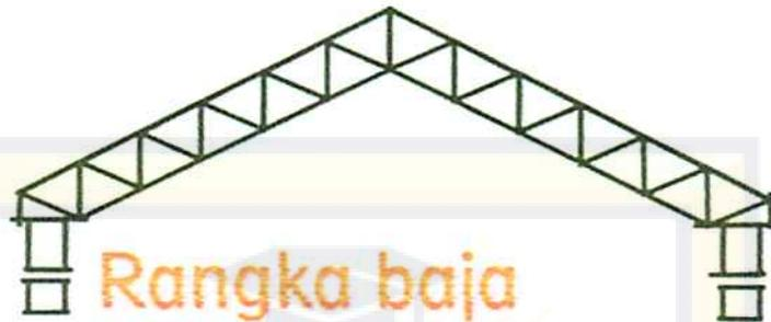
Gambar 5.20 Sistem Struktur Atap
