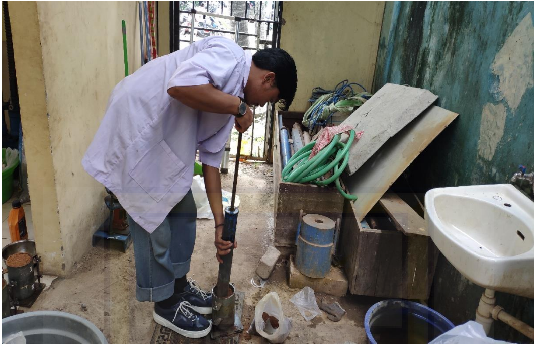
Dokumentasi proses pengujian pemadatan tanah ( Compaction ).
