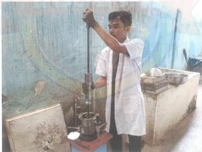
Gambar 6. Pembuatan benda uji dengan 75 kali tumbukan setiap sisi
