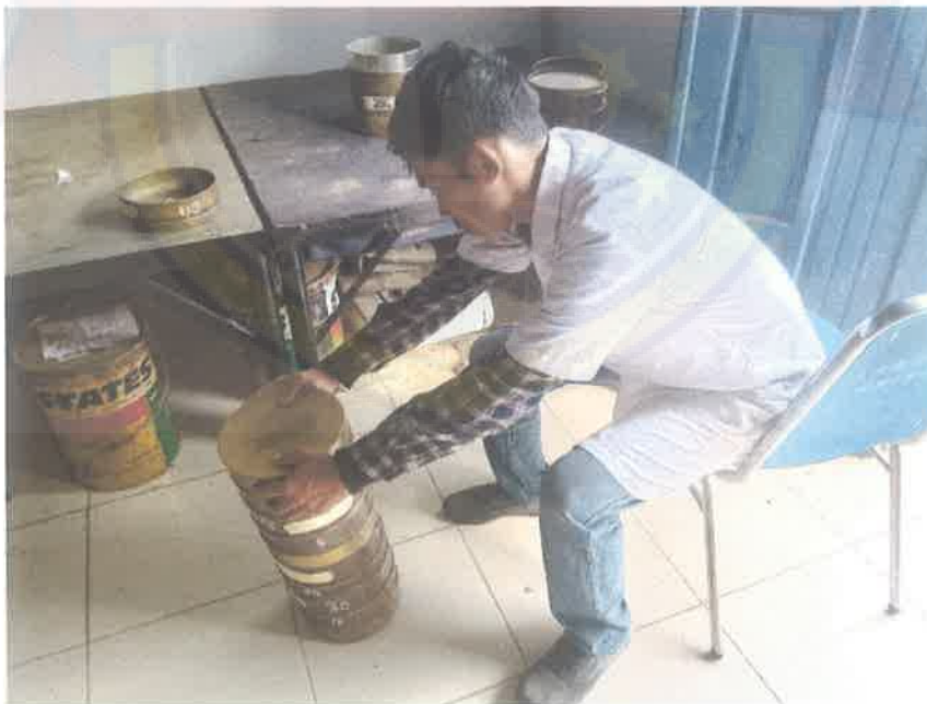
Gambar 2. Analisa saringan agregat kasar dan halus
