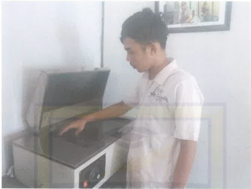
Gambar 11. Perendaman di waterbath selama 30 menit dengan suhu 60°C
