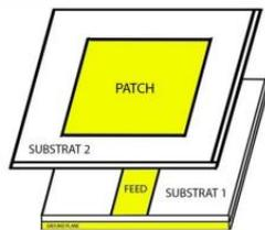
Gambar 3. Lapisan antena Mikrostrip
