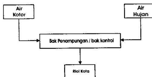
Gambar 4.13 Skema pembuangan Air kotor
