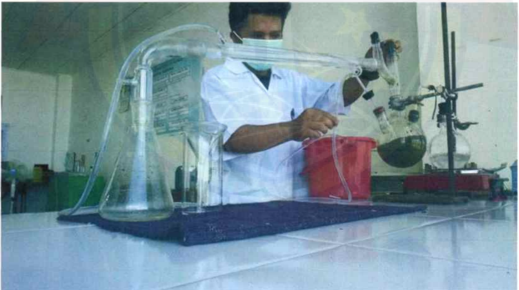
Pengaturan suhu alat destilasi
