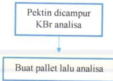
**Gambar 3.6** Proses analisa FTIR
