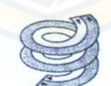
19 Tanjakan spiral, jalur turun dan naik saling berdampingan
