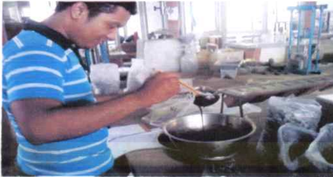
Rabu 13-04-2011 Jam 11.32 Proses Pencampuran Aspal Emulsi Dengan Material Lain (Abu Batu, Split 0,5-1, Split 1-2)
