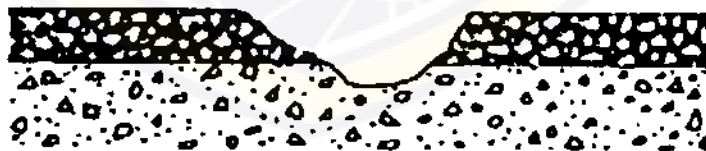
Gambar IV.5 Jalan dalam keadaan lubang
