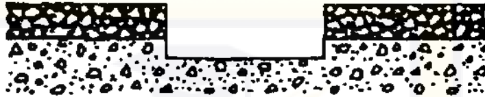
Gambar IV.6. Lubang dipotong berbentuk persegi
