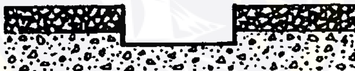
Gambar IV.7 Lubang dioles dengan lapis perekat
