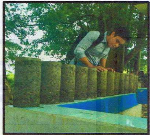
Pengangkatan Sampel Setelah Perendaman 28 Hari
