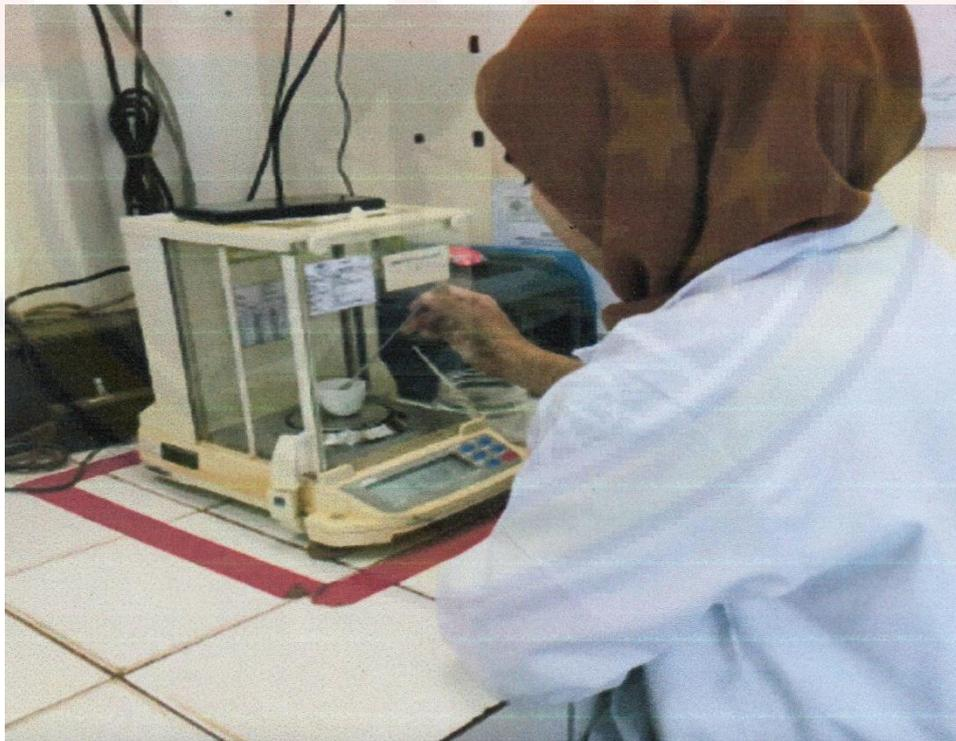
Sampel pulp 200 mesh dan flux ditimbang
